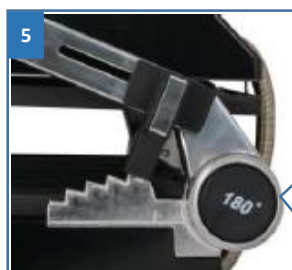
Жұмыс беттерді 180°-қа жазу батырмасын абайлап басыңыз
